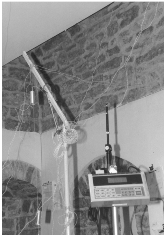
Fig. 2 – Termocoppie e centralina microclimatica.
